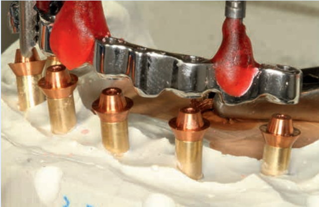
Der SAE-Funkenerosionsprozess mit Elektroden The SAE spark erosion process with electrodes
