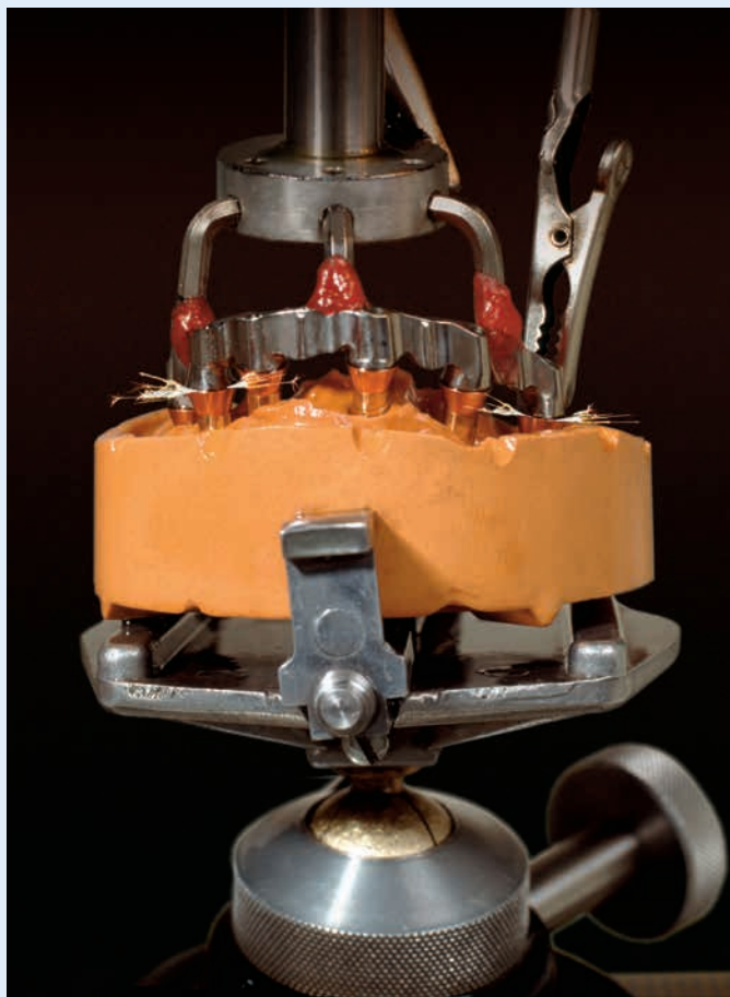
Passivierung der Implantatstruktur auf 6 Modellanalogen-Kupferelektroden mit standardisiertem Oberflächen-Design Passivation of the implant structure on 6 model analogues - copper electrodes with standardised surface design
