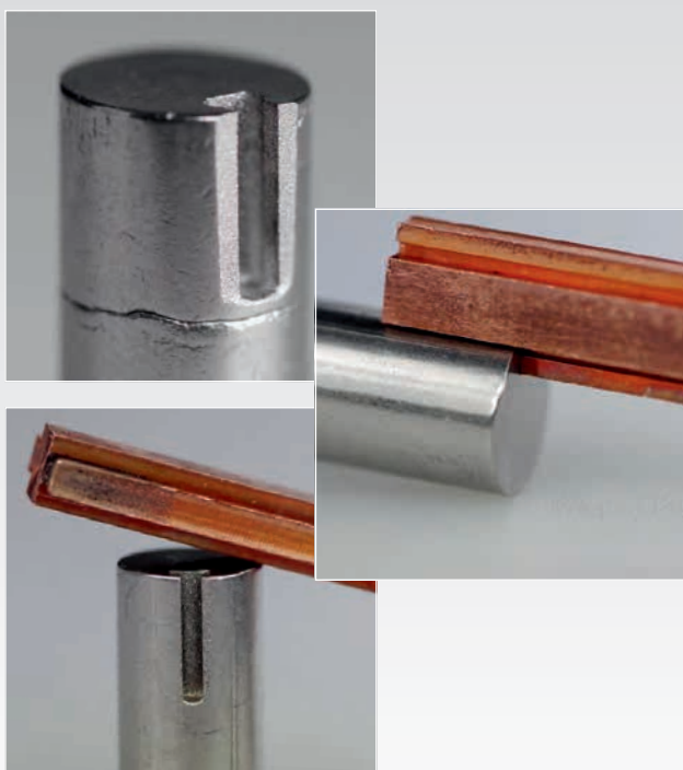
T-Geschiebe, ein Arbeitsgang Schruppbearbeitung
