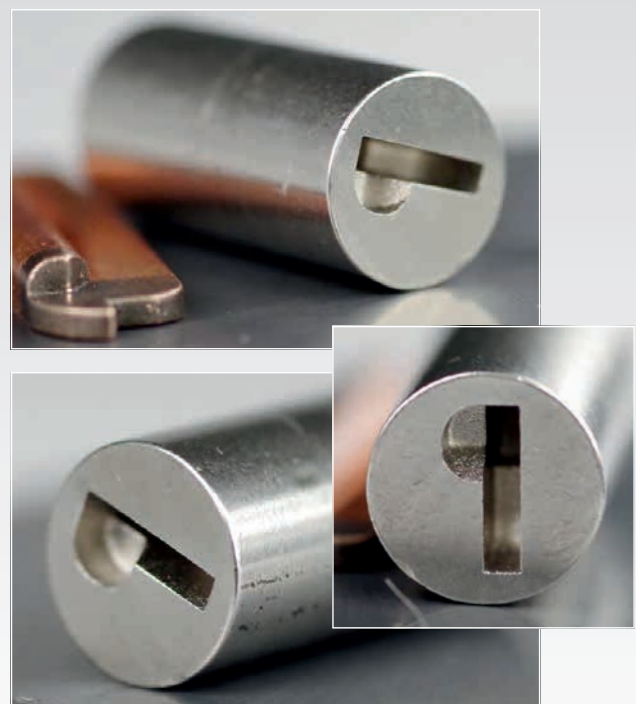
Schwenkriegel, ein Arbeitsgang Schruppbearbeitung
